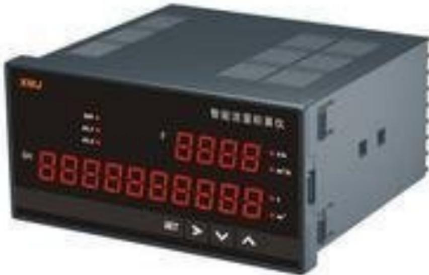
仪器仪表故障诊断:1、敲击手压法我们使用仪器时，经常会遇到仪器运行时好时坏的现象，这种现象绝大多数是由于接触不良或虚焊造成的。对于这种情况可以采用敲击与手压法。所谓的“敲击”就是对可能产生故障的部位，通过小橡皮榔头或其他敲击物轻轻敲打插件板或部件，看看是否会引起出错或停机故障。所谓“手压”就是在故障出现时，关上电源后对插的部件和插头和座重新用手压牢，再开机试试是否会消除故障。如果发现敲打一下机壳正常，再敲打又不正常时，比较好先将所有接头重插牢再试，若不成功，只好另想其它办法。2、观察法利用视觉、嗅觉、触觉。某些时候，损坏了的元件会变色、起泡或出现烧焦的斑点;烧坏的器件会产生一些特殊的气味;短路的芯片会发烫;用肉眼也能观察到虚焊或脱焊处。3、排除法所谓的排除法是通过拔插机内一些插件板、器件来判断故障原因的方法。当拔除某一插件板或器件后仪表恢复正常，就说明故障发生在那里。4、替换法要求有两台同型号的仪器或有足够的备件。将一个好的备品与故障机上的同
